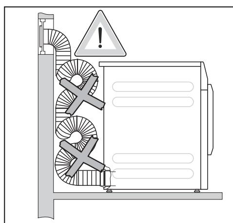
Kondenzat može otjecati u sušilicu. Odvodno crijevo ne polažite u petlju. Skratite odvodno crijevo na potrebnu duljinu.
