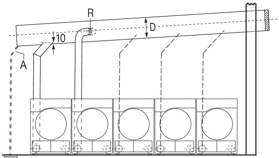
**A** = Odvod za kondenzat
