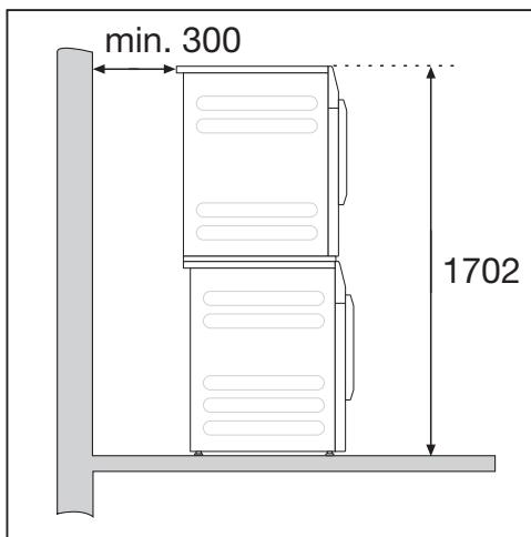
Potreban je komplet za povezivanje\*. Ugradnju vrši samo od strane tvrtke Miele ovlašteno stručno osoblje.
