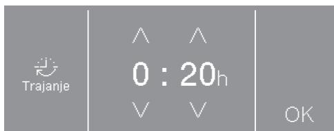
Dodirnite strelice  $\wedge$  i  $\vee$  i potvrdite senzorskom tipkom OK.
